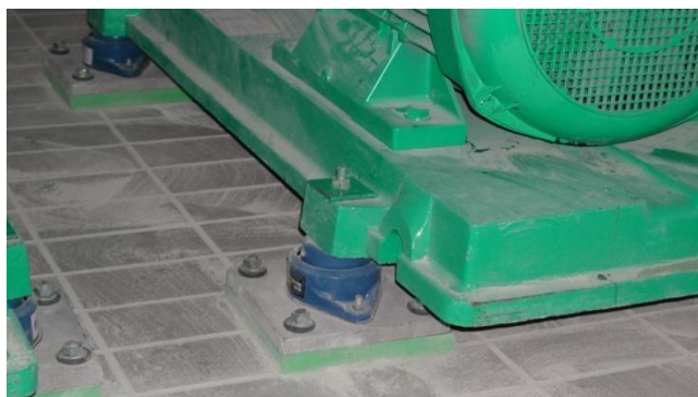
Εικόνα 5.3 - Έδραση Αντλίας
